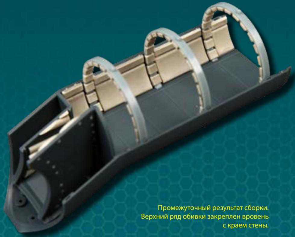
Промежуточный результат сборки. Верхний ряд обивки закреплен вровень с краем стены.
